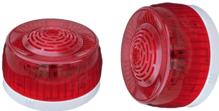
JBF5174-Ex火灾声光报警器应用于青鸟消防JBF-11SF和JBF50XX火灾报警系统中, 当公共场所发生火灾时, 控制器发出火警命令, 火灾声光报警器发出高分贝火警声, LED灯闪烁。本产品属于本安型火灾声光报警器, 在用于石油、石化等具有防爆要求的1区及2区室内(非住宅内)防爆场所时, 需配接符合本安要求且具有[Ex ib Gb]IIC及以上防爆认证的安全栅使用。
