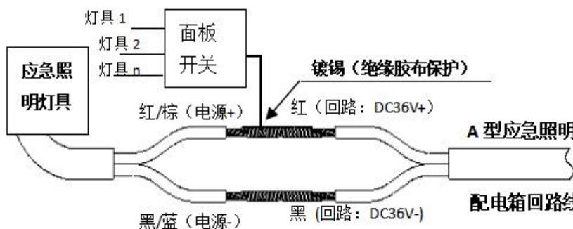
灯具出厂自带一根强启线（灰色），灯具如需兼做日常照明，可通过在回路线上加装开关来实现控制，如果单个开关要控制多个灯具则将各灯具强启线并联至开关下端，如上图所示。
