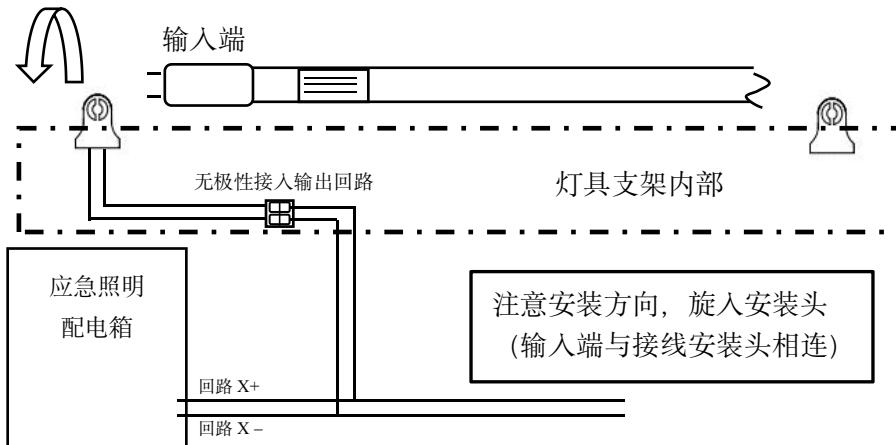
灯具单侧供电，安装时应注意灯具的输入端（产品标签侧）应与灯架的接线端安装头相连接（灯具输入端无极性）。
