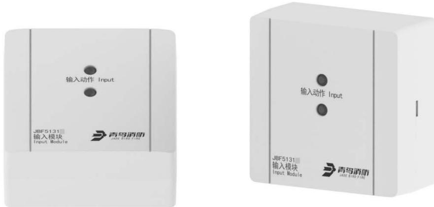
JBF5131A、JBF5131C 型输入模块(以下简称模块)是青鸟消防开发的可实现输入监测功能的模块。该模块通过被监视设备动作后提供的常开或常闭无源触点信号, 点亮“输入动作”指示灯来示意反馈, 并将反馈信号传送到消防联动控制器。
