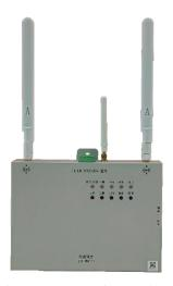
JBF-WR111 无线中继器是针对为青鸟消防 HRP 系统无线终端设备与无线网关通讯连接而设计的一款无线中转器。其主要功能是当无线终端安装位置超出无线网关的通讯接收范围时,将无线终端发送的无线数据转发给无线网关,达到延长无线终端与无线网关之间通信距离的目的。
